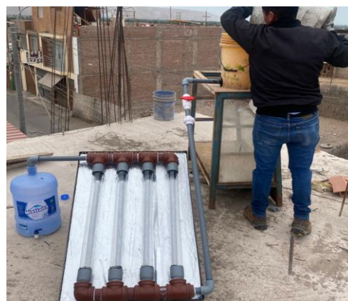
Fig.9 Sistema en proceso de desinfección de F.H.
