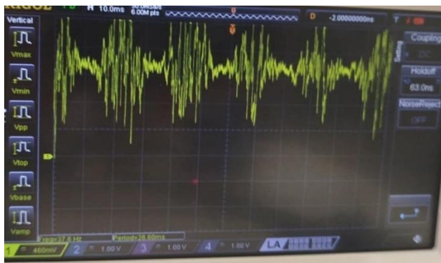
Figura 4: señal de audio de la FFT antes del filtro. Fuente: Propia.
