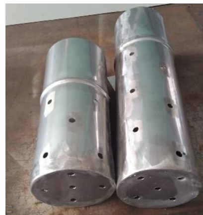
Fig. 3 Moldes cilíndricos de acero inoxidable de 10x15 cm y 10x25 cm.
