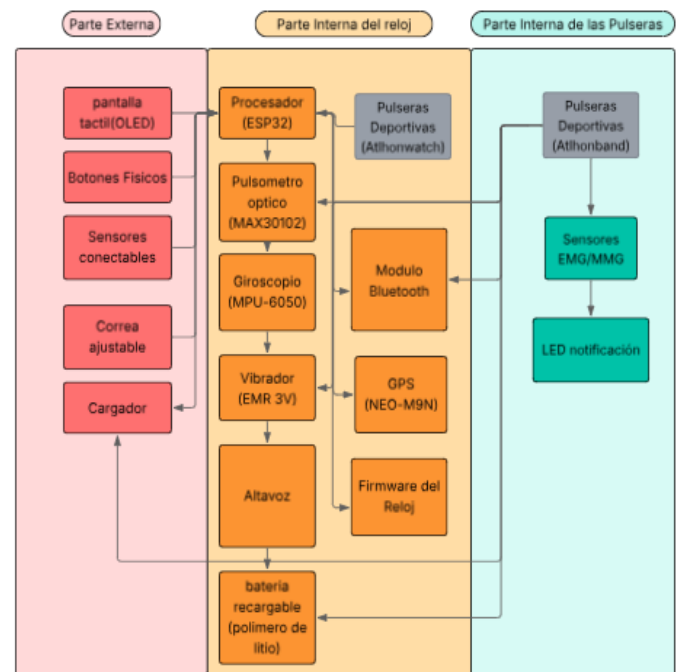
Fig. 4. Diagrama de funcionamiento de reloj deportivo antilesivo y pulseras deportivas.
