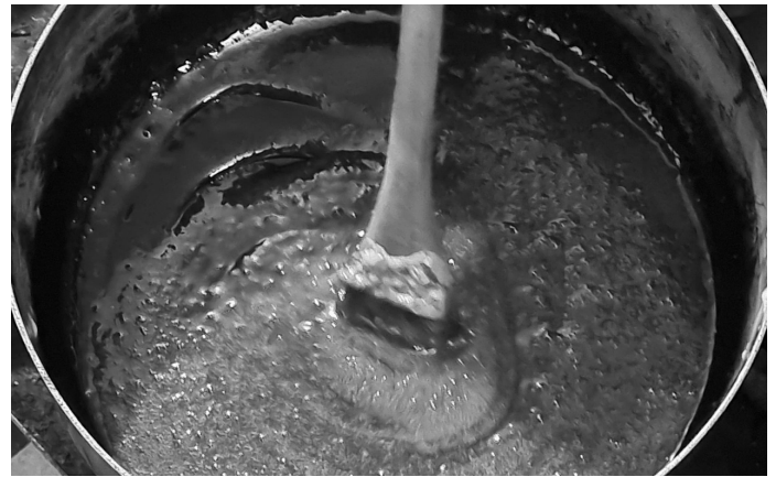
Fig 4. Fundido del Polietileno Tereftalato (PET).
