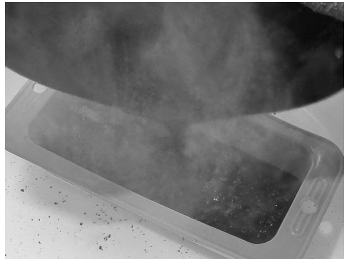
Fig 5. Vertimiento de la mezcla al molde.
