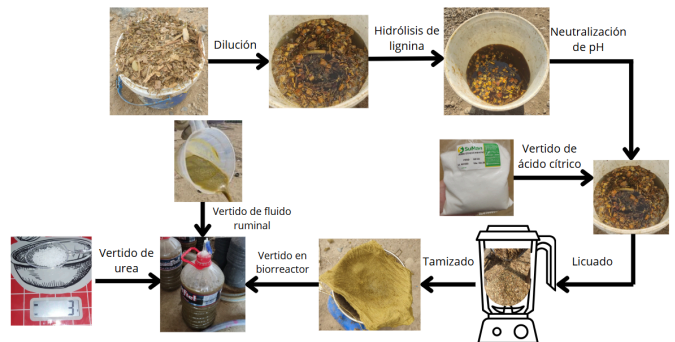
Figura 2. Diagrama de flujo de pretratamiento en forraje seco.
