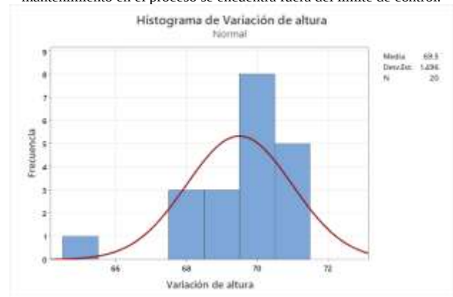
Fig. 5 Histograma de variación de altura Nota. En la presente figura se muestra la variabilidad en la altura en las carpetas metalmecánicas. Esta representación permite analizar la variabilidad de las dimensiones y la consistencia del proceso de fabricación.
