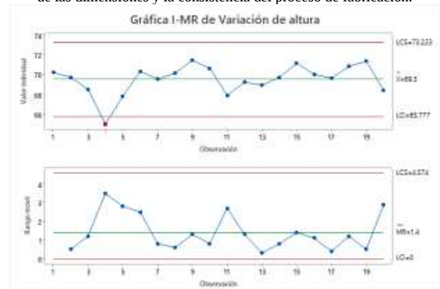
Fig. 6 Gráfica de control CR-2 Nota. En la presente figura se muestra que la variación de la altura se encuentra bajo control estadístico.
