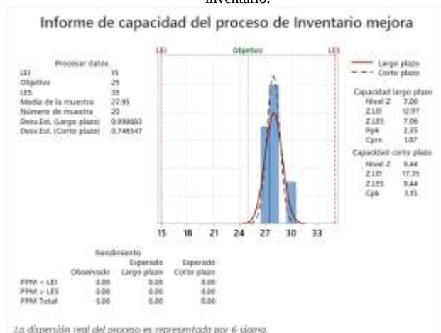
Fig. 21 Gráfica Six Sigma mejorada CR-4 Nota. Muestra la reducción de la variabilidad y mejora en la gestión del inventario tras las optimizaciones implementadas.
