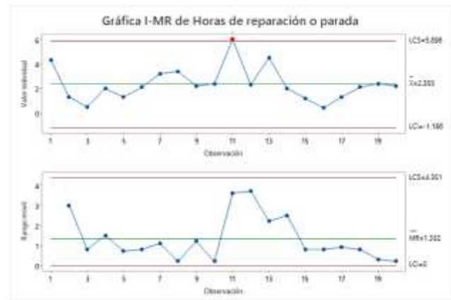
Fig. 4 Gráfica de control CR-1 Nota. En la presente figura se muestra que el número de horas de mantenimiento en el proceso se encuentra fuera del límite de control.
