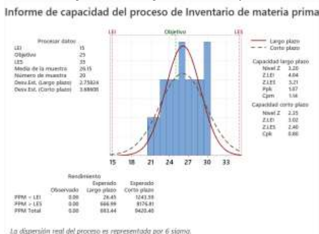
Fig. 21 Gráfica Six Sigma del informe de capacidad del proceso de inventario de materia prima. Nota. Muestra la variabilidad y el rendimiento en la gestión del inventario.
