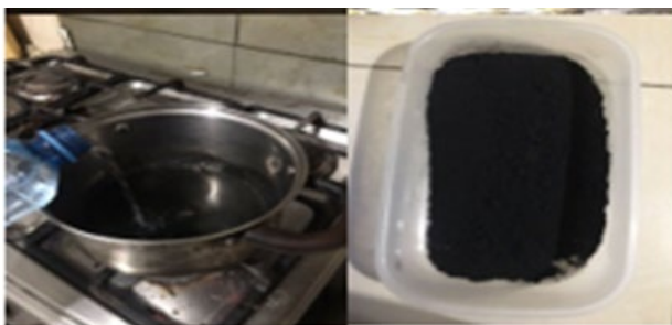
Fig. 2 Elaboración de carbón activado a base de bagazo de caña de azúcar
