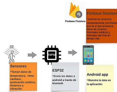
Fig 8. Diagrama de flujo de recepción y envío de señales electrónicas al móvil
