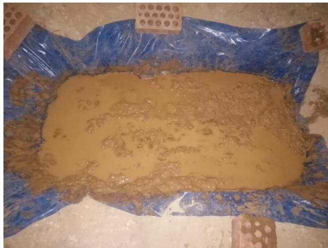
Fig. 3 Proceso de maduración del barro dormido
