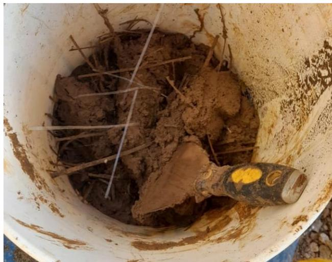
Fig. 2 Incorporación del PET a la mezcla de Adobe según sea la dosificación de cada muestra (5%, 10%, 15%).
