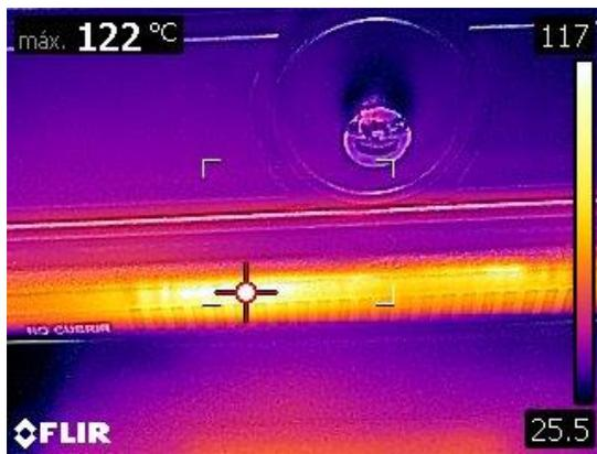
Fig. 4 Medición del calor emitido por el calentador eléctrico mediante cámara termográfica.
