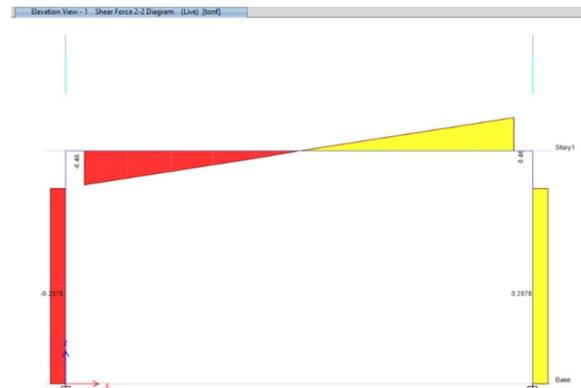
Fig. 11 Cortante para carga viva del pórtico.
