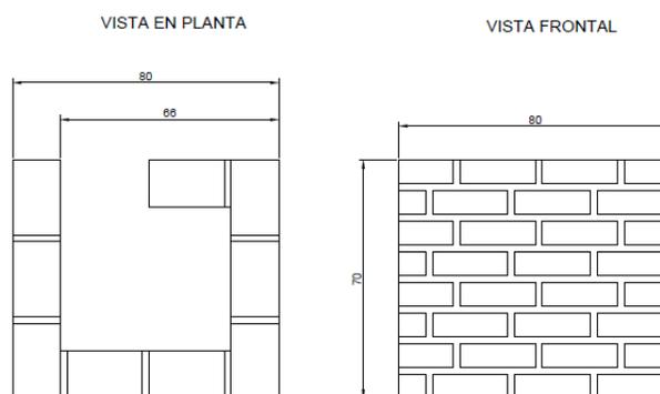
Fig. 2 Vista en planta y frontal de la estructura fabricada con ladrillos.
