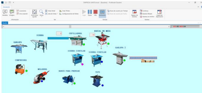
Fig. 18 Simulación de la nueva distribución de la Carpintería Sarita luego de aplicar hexágonos
