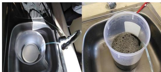
Fig. 8 Aplicación del ozono al lixiviado (1 de 2)
