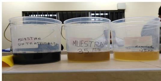
Fig. 10 Cambio de color del lixiviado
