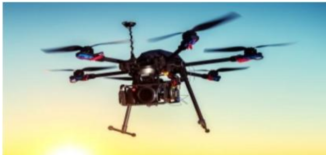
Fig. 5. Hexacóptero empleado para aplicaciones de monitoreo ambiental y adquisición de datos térmicos. Adaptado de [7] y [31].
