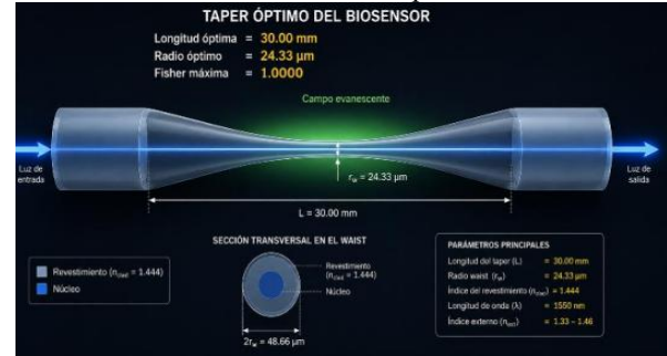
Fig 4. Diseño conceptual de un biosensor basado en fibra óptica tipo taper optimizado mediante el criterio de Fisher para maximizar la sensibilidad y la capacidad de discriminación. Fuente: Elaboración propia con asistencia de IA generativa (OpenAI)
