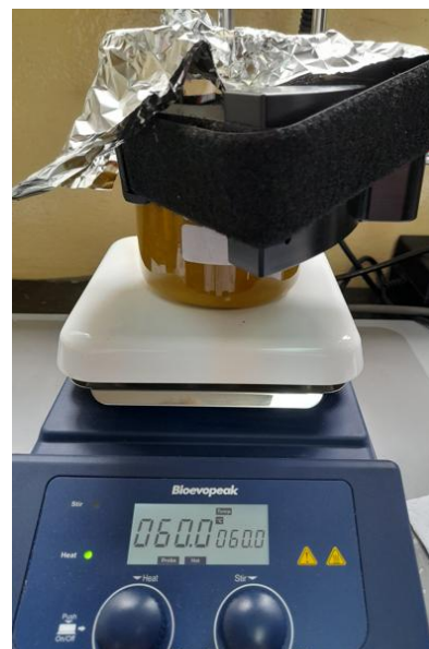
Figura 10. Pretratamiento térmico realizado a 60°C
