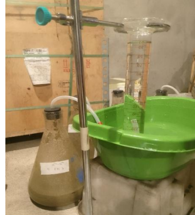
Fig. 2 Medición de volumen por desplazamiento de agua
