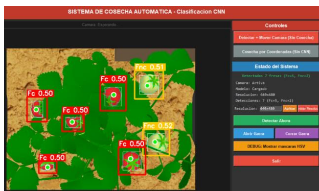
Fig. 10. Captura del sensor de visión con detección y clasificación del fruto.
