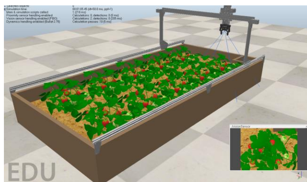
Fig. 9. Robot posicionado sobre la planta de fresa en CoppeliaSim.
