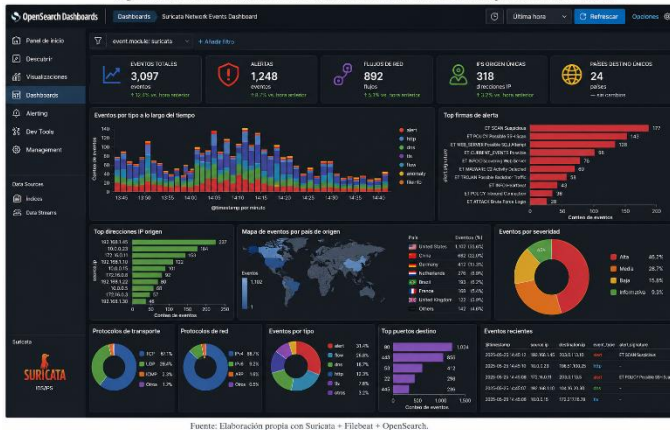
Fig. 3. Detección de tráfico sospechoso mediante IDS basado en Suricata. Fuente: Elaboración propia.
