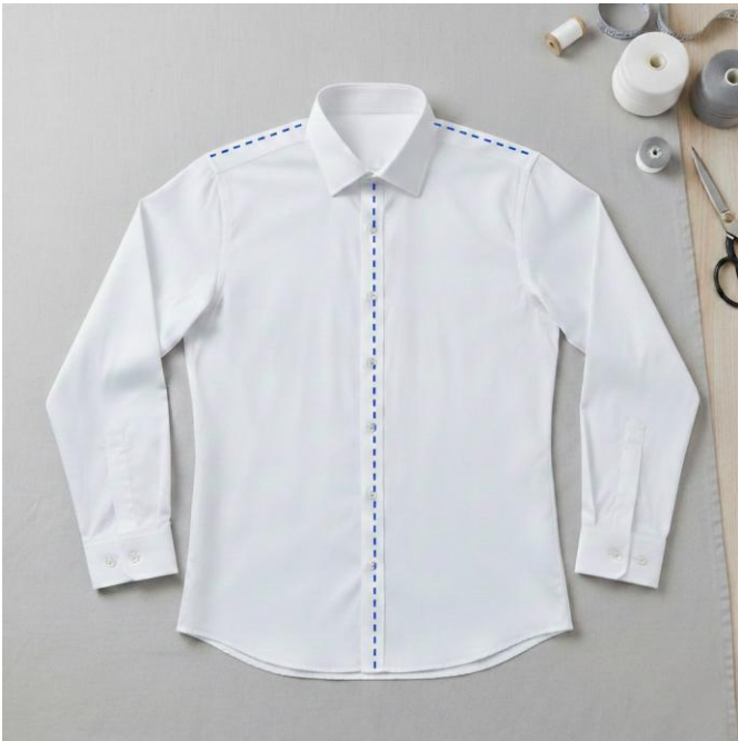
Fig. 1 Representación de las tres operaciones de costura plana simuladas en Adept ACE. Las líneas discontinuas en azul indican las trayectorias de costura correspondientes a la tapeta frontal, el hombro y el bolsillo aplicado.
