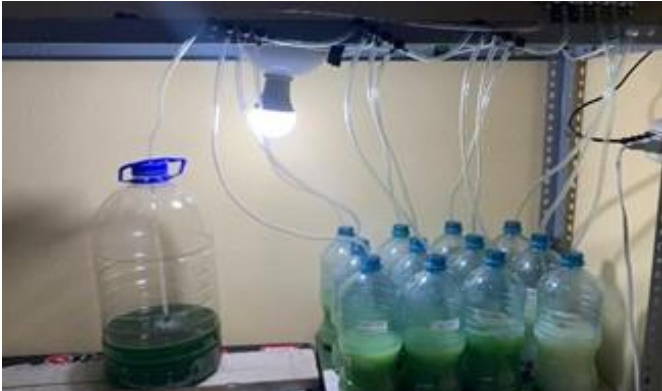
Fig. 1 Sistema de biorreactores diseñados para el cultivo de Scenedesmus sp. en el tratamiento de agua residual láctea.
