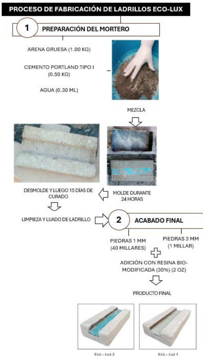
Fig. 4 Proceso básico de proceso de fabricación de Ladrillos Eco-Lux
