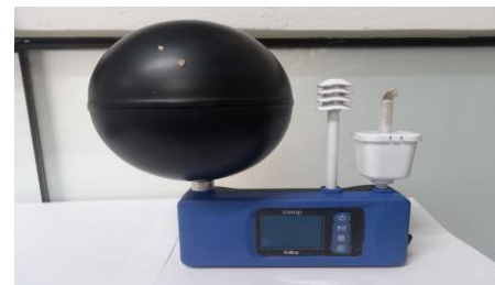
Fig. 4. Equipo de medición (TG, TBH, TA) para la evaluación del estrés térmico.
