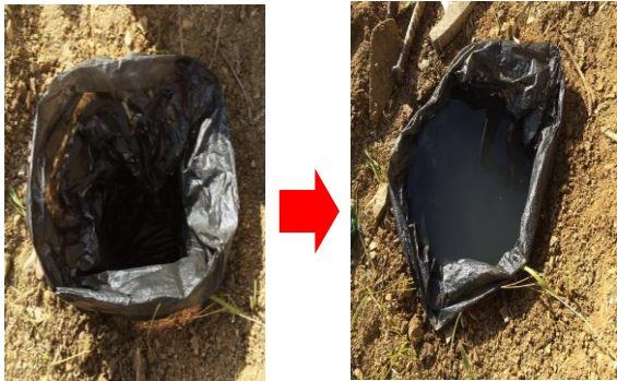
Fig. 6 Ensayo de densidad natural ejecutado mediante el método de reemplazo de agua en el talud N°1 para la obtención de la densidad del suelo.
