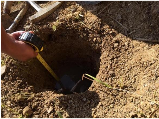
Fig. 7 Ensayo de prueba de infiltración del talud N°1
