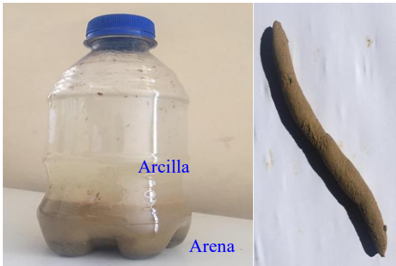
Fig. 4 Prueba de la botella para ver la composición del suelo
