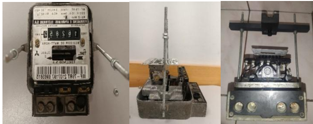
El medidor eléctrico analógico es de la marca EDELNOR S.A., este se caracteriza por contar con una pantalla de dígitos mecánicos que muestra el consumo acumulado de electricidad en kilovatios hora (kWh). Muy usado en zonas rurales y de telemedición nula. A este medidor se acopló y adaptó espárragos de 3/16 pulgadas en sus laterales (Fig.3), que actúan como puntos de anclaje para fijar de manera estable la base estructural impresa en 3D y ajustar la distancia de enfoque de la Cámara a la numeración, sostiene el microcontrolador y el módulo.
