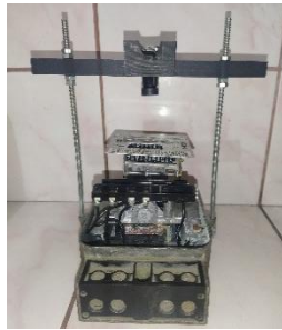
Fig.10. Ajuste de OV2640 con un ángulo de visión de 120° ajustable
