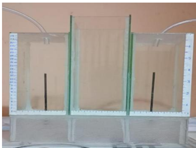
Fig. 2. Prototipo experimental de electrólisis alcalina para la producción de hidrógeno, basado en el diseño propuesto por Vilca Callata [7].
