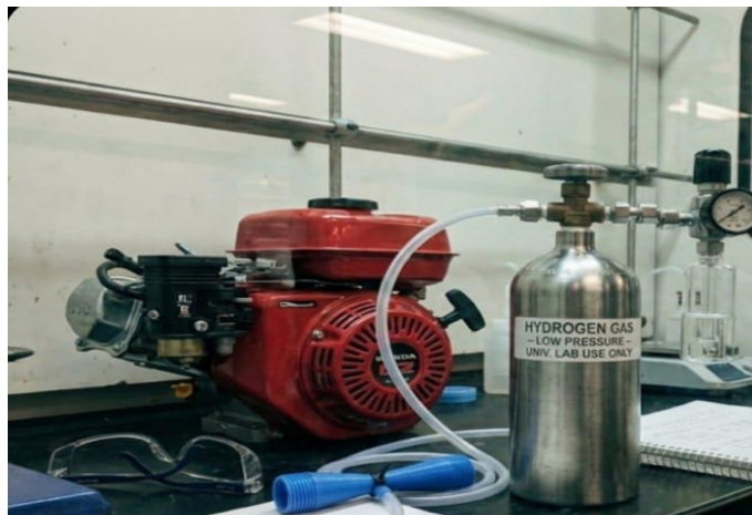
Fig. 5. Montaje experimental final utilizado durante los ensayos, incluyendo el sistema de suministro de hidrógeno con regulación de presión y su conexión al motor monocilíndrico dentro de un entorno controlado.
