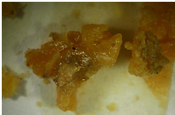
Fig. 9 Ceras producto de la copirólisis del LDPE y PET a 600 °C, 3 h de tiempo de residencia y 5 mm de tamaño de partícula.
