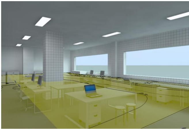
Fig.10 Simulación 3D del software DIALUX del área de producción
