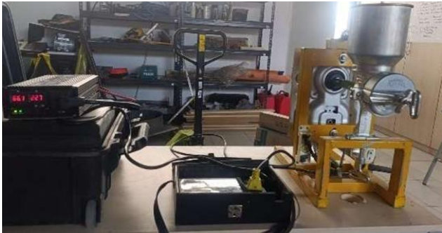
Fig. 13 Medición de voltaje, corriente y potencia con vatímetro
