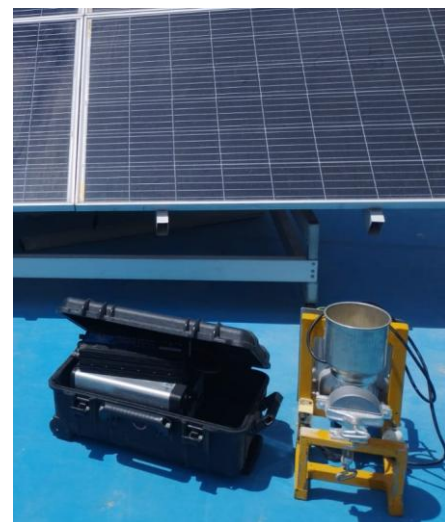
Fig. 11 Prototipo final con panel, batería, inversor y molino
