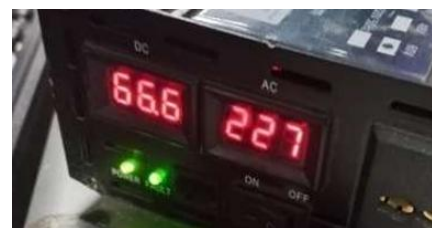
Fig. 12 Voltaje suministrado por el inversor
