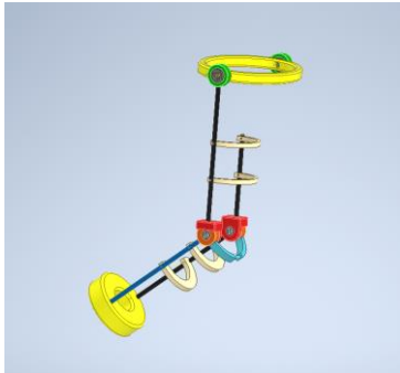
Fig. 2. Diseño preliminar del mecanismo, mostrando la disposición de anillos y bielas según parámetros antropométricos y cinemática de flexión-extensión [50].
