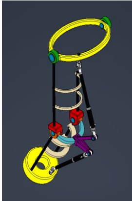
Fig. 4. Modelo final del dispositivo con PMA representados como cilindros de carrera equivalente (20 %), integrando anillos en fibra de carbono y bielas en aluminio para optimizar resistencia, peso y ergonomía [51], [59], [60].
