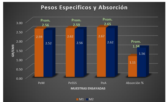
Fig. 5 Pesos específicos y absorción del agregado fino de río.
