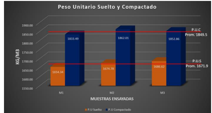
Fig. 4 Peso unitario suelto y compactado del agregado fino de río.
