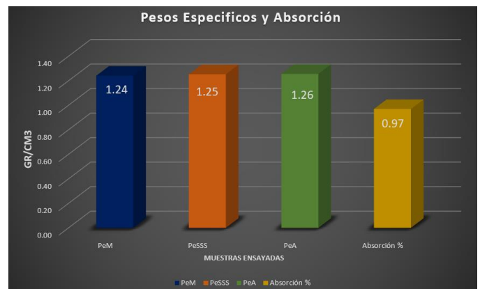
Fig. 9 Pesos específicos y absorción del agregado grueso de río
