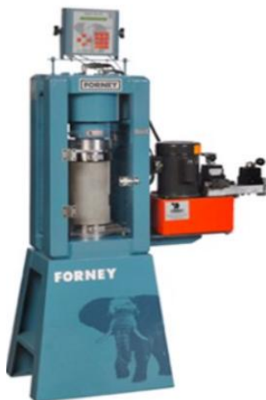
Fig. 3 Máquina de ensayo con capacidad adaptable para pruebas de flexión, marca FORNEY.
