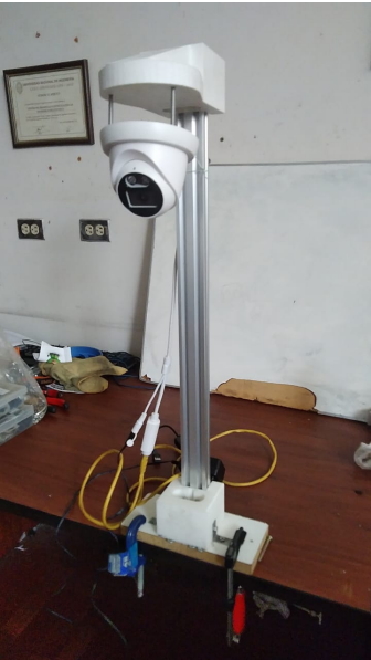
Fig. 4. Estructura mecánica armada
