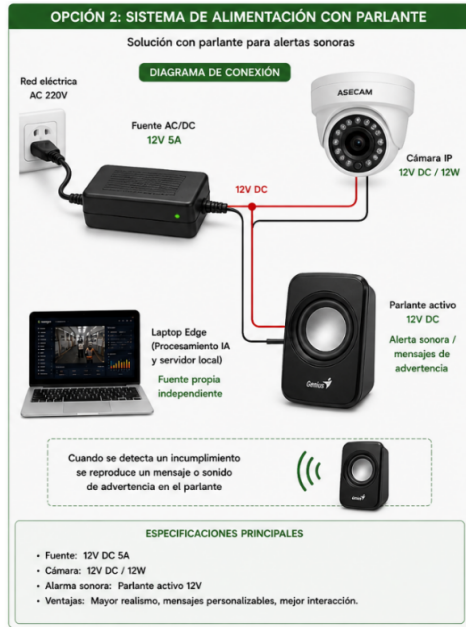
Fig. 5. Esquema de diseño de circuit o de alimentación
