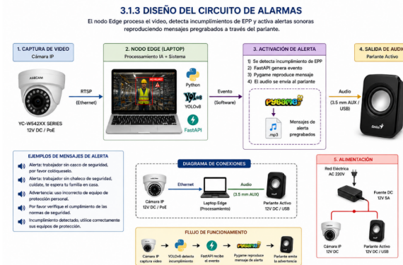
Fig. 6. Esquema de diseño de circuito de alarmas
