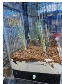
Fig. 4: Prototipo SUDS a escala piloto, Área de Biorretención.
