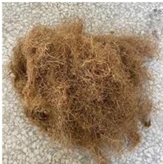
Fig. 5. Fibras naturales de bambú utilizadas como refuerzo en concreto con agregados reciclados. Adaptado de Xu et al. (2024) [22].
