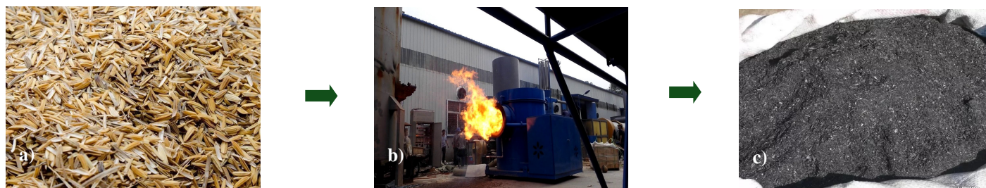
Fig. 1. Proceso de CCA: (a) Cascarrilla de cáscara de arroz, (b) Combustión en horno, (c) Ceniza de cascara de arroz
