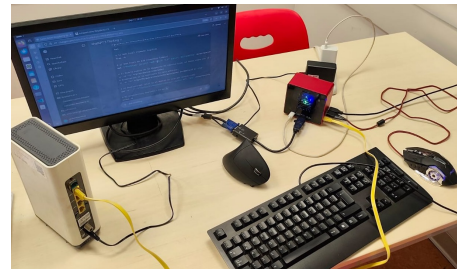
Fig. 2. Banco de pruebas del sistema biométrico VPN PLC.
