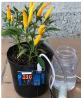
Fig. 4 Montaje del sistema de riego automatizado
