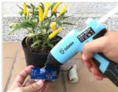
Fig. 3 Aplicación del adhesivo caliente al prototipo
