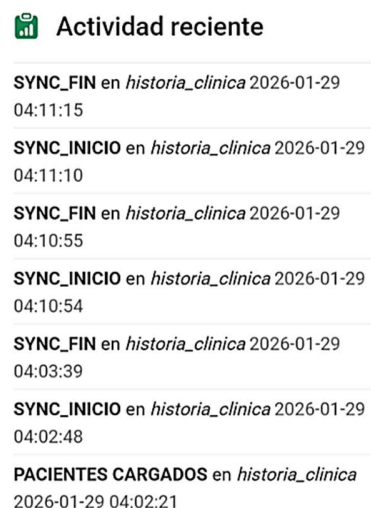
Fig. 10. Pacientes cargados a las 4:02:21, inicio de sincronización a las 4:02:48 y finalización a las 4:03:39 con confirmación
