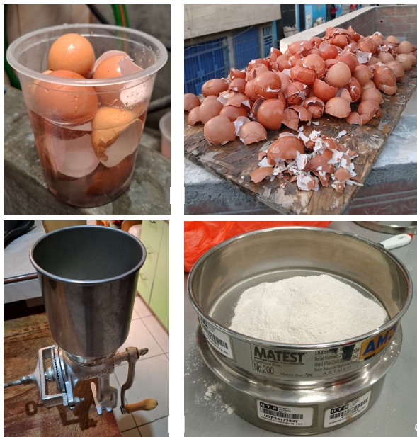
Fig. 3 Producción de ESP: (a) Material de cáscara de huevo sumergido en hipoclorito, (b) Secado a la intemperie, (c) Molienda en molinillo, (d) ESP pulverizado.
