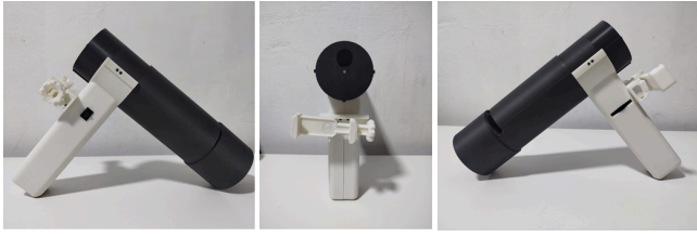
Fig. 9 Prototipo de retinógrafo portátil impreso en 3D
