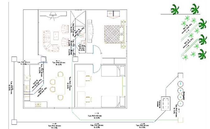
Figura 3. Esquema de distribución del sistema de biodigestión y reutilización agrícola del efluente.
