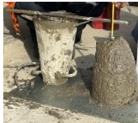
Fig. 5. Muestra de medición del Slump del concreto.
