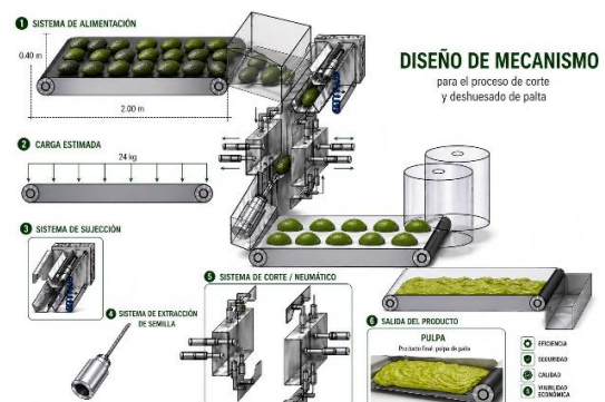
Fig. 21 Propuesta del mecanismo completo.
