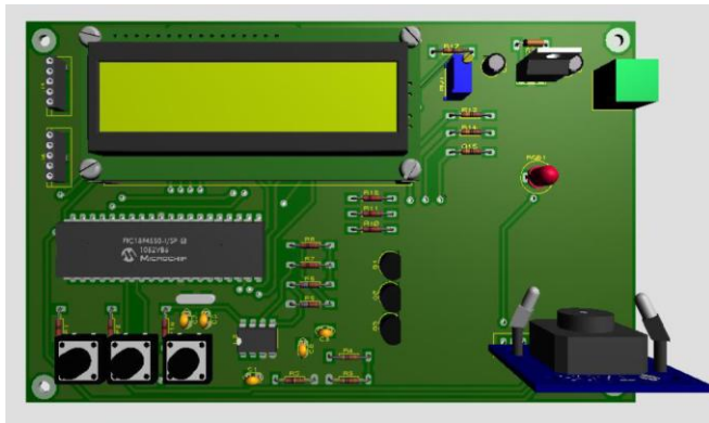
Fig. 2. Modelo 3D del dispositivo fotométrico mostrando las interconexiones entre módulos
