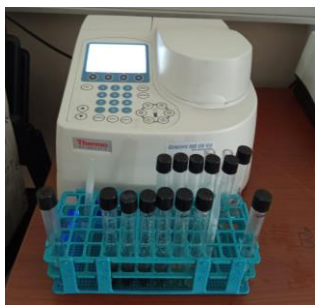
Fig. 3 Medición espectrofotométrica de estándares para curva de calibración
