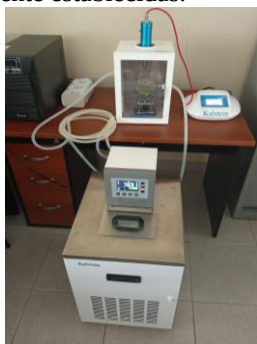
Fig. 4 Equipo de extracción asistida por ultrasonido
