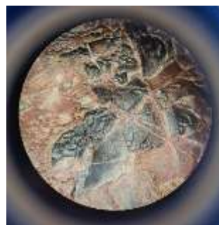
Fig. 9 Septaria muestra S-4 bajo el microscopio estereoscópico universal con aumento por 14
