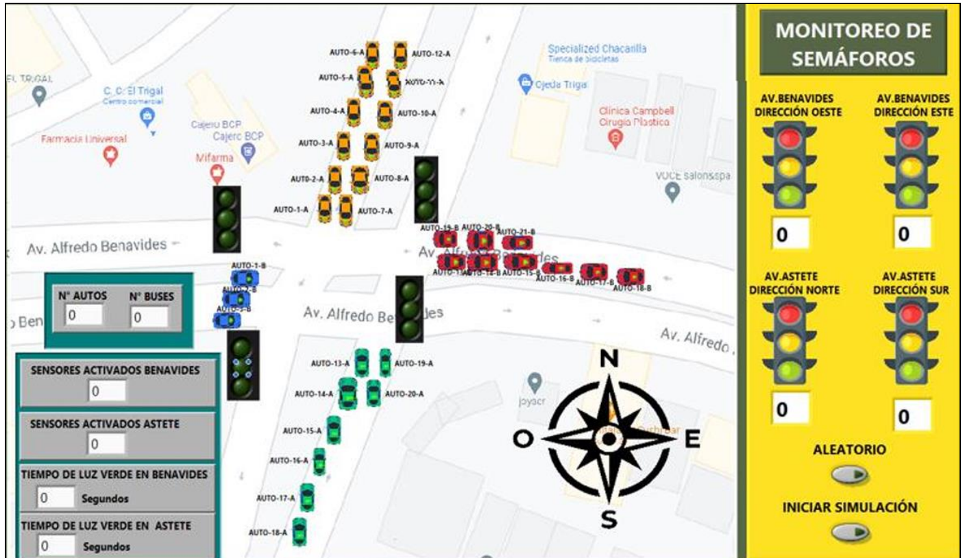
Fig. 3. Interfaz gráfica realizada en la ventana Panel de Control del software LabVIEW, para el entorno simulado.
