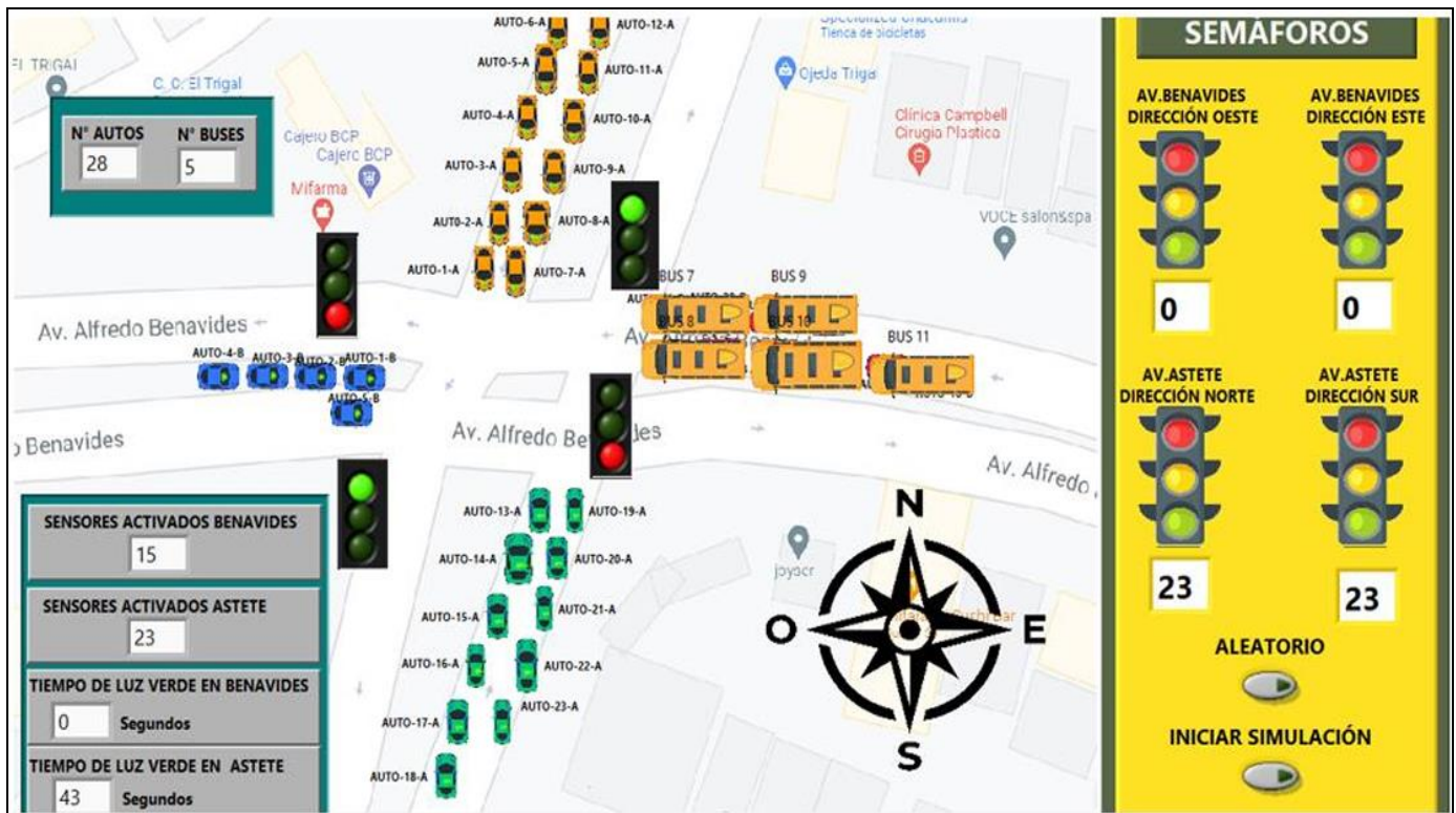
Fig. 7. Simulación de una recreación de tráfico vehicular en el entorno desarrollado en el software LabVIEW.
