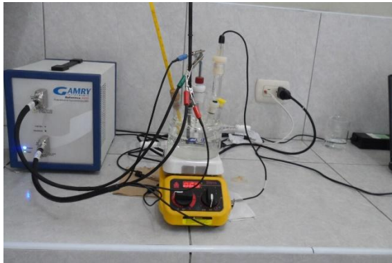
Fig. 2 Montaje experimental del sistema electroquímico con celda de tres electrodos utilizado para los ensayos de corrosión.
